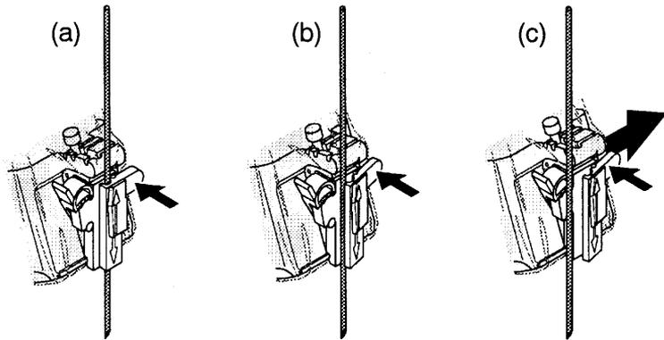
Рис. 5-20. Отсоедините иглу от устройства
