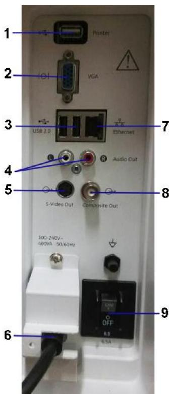
Рис. 1-2. Панель разъемов для подключения периферийных/дополнительных устройств
