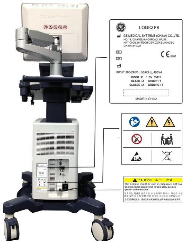
Рис. 4-6. Расположение таблички с техническими данными системы LOGIQ F8
