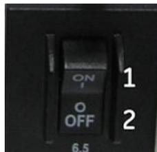
Рис. 1-10. Автоматический выключатель (размещенный на задней панели системы)
