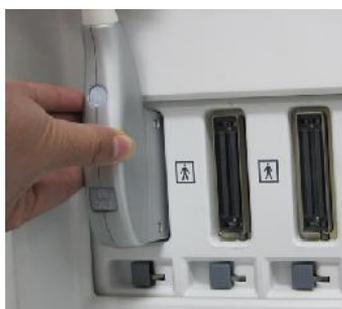
Рис. 1-13. Подсоединение датчика
