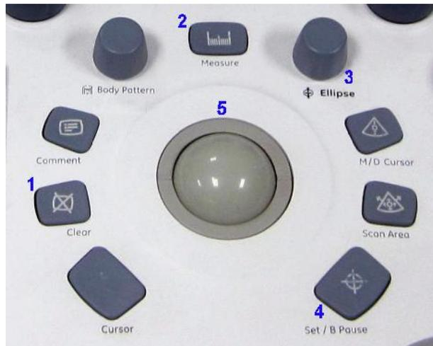
Рис. 2-18. Местоположение элементов управления измерением
